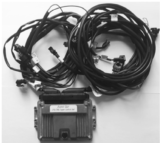
Рис. 6. ЕБУ Avenir Gaz 37 з підключеними роз'ємами та дротами до датчиків і пристроїв
